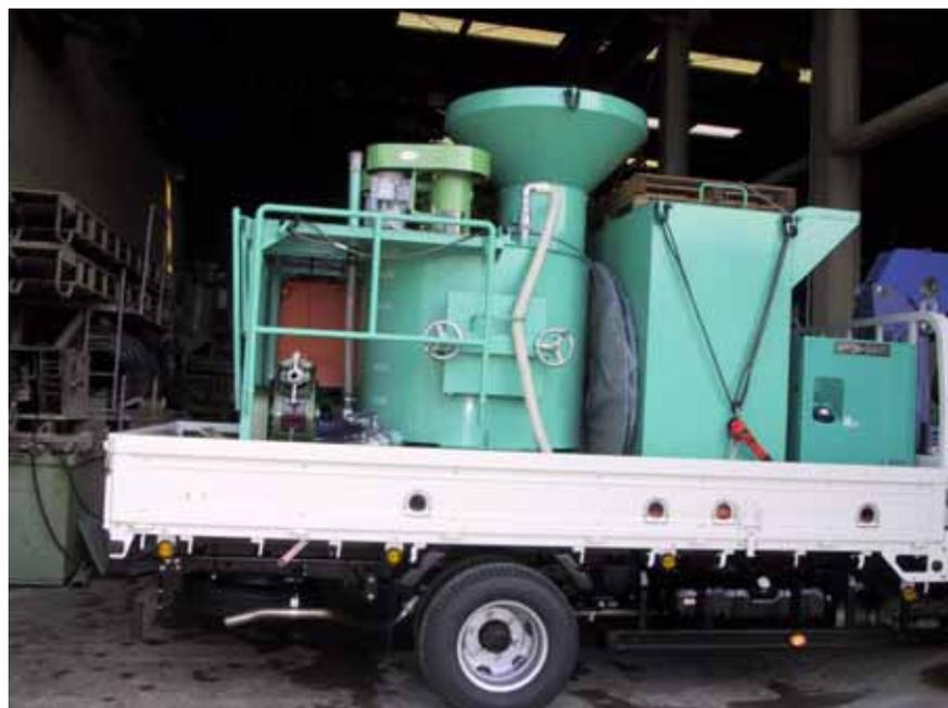
ミキサー1200リットル チュウピングポンプ max 毎分78ℓインバーター制御 水タンク2t 防塵カバー付
